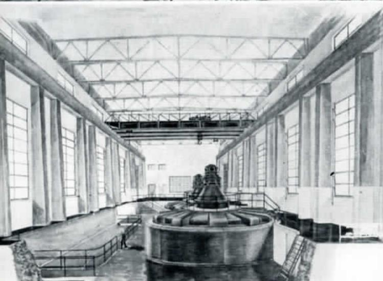
La Centrale Idroelettrica di Agra sul fiume Vodas, in Macedonia, come appare nel progetto costruttivo. La potenza installata della Centrale sarà di 49 000 kW.
