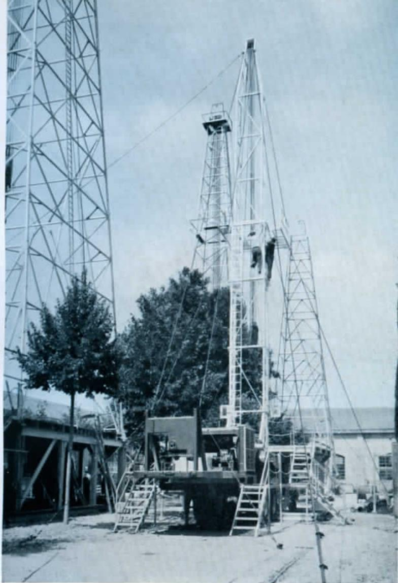
La Soc. « J. Massarenti - Piacentina di Perforazioni » progetta e costruisce impianti di perforazione sistema Rotary ed esegue pozzi per ricerche di idrocarburi, vapore ed acqua. Nella fotografia una veduta dei piazzali di montaggio; in primo piano una sonda automontata per media profondità ed in secondo piano un impianto di perforazione sistema Rotary per 4 500 m di profondità.
